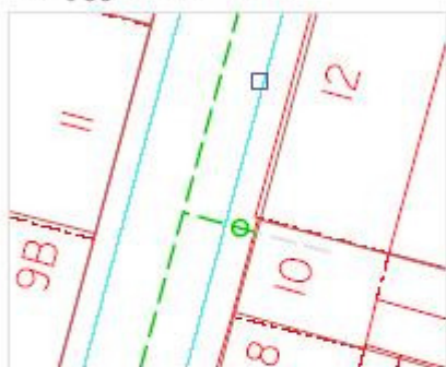
Tilslutningsprincip med fællesskelbrønd hvor bebyggelse er i skel
