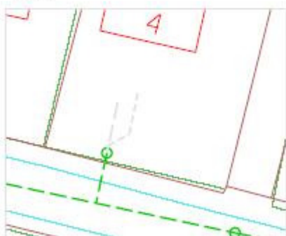
Tilslutningsprincip med spildevand og regnvand til fællesskelbrønd hvor bebyggelse ikke er i skel
