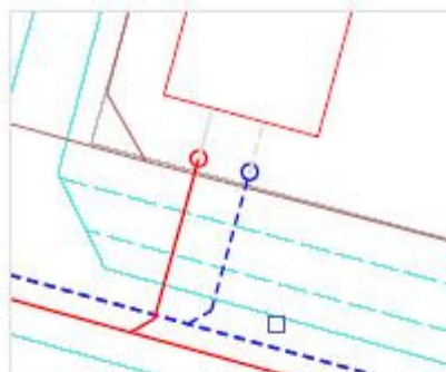
Tilslutningsprincip med spildevand og regnvandsskelbrønde hvor bebyggelse ikke er i skel
