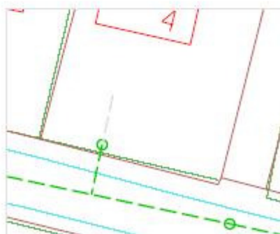
Tilslutningsprincip med fællesskelbrønd hvor bebyggelse ikke er i skel
